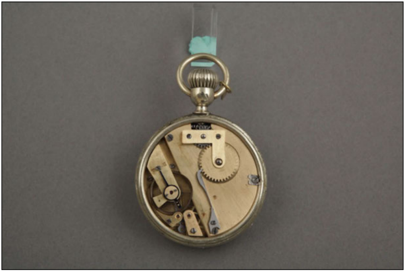
Abb. 5a: Roskopf-Bewegung mit Klinke aus einem Stück.
