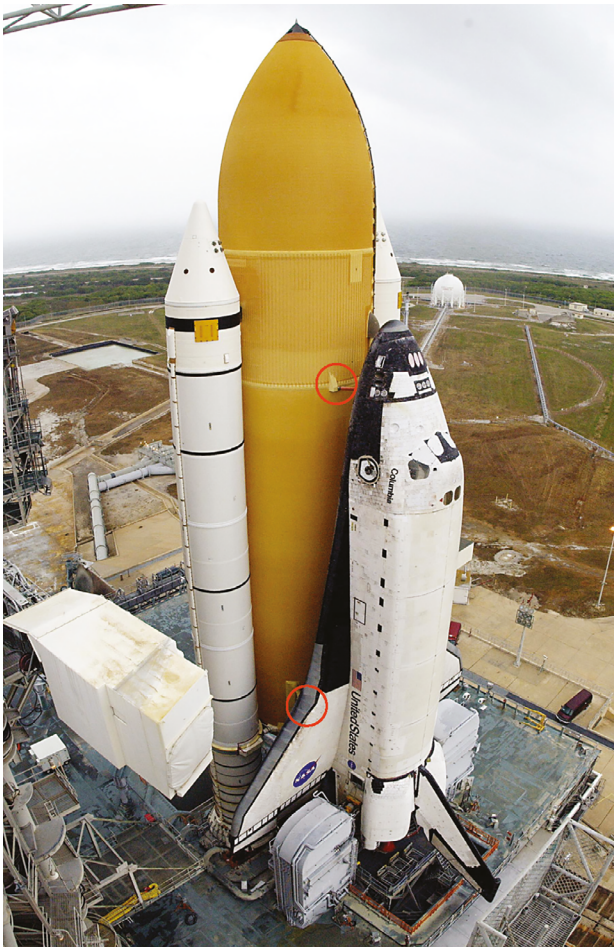
Abb. 3.4: Columbia Space Shuttle in der Startvorrichtung. Die beiden Kreise markieren die Beschädigung am Außentank sowie am linken Flügel, die in der Folge zum Unglück beim Wiedereintritt führen.
